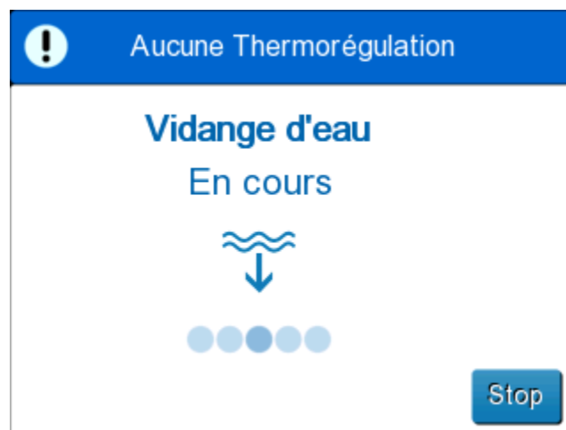
Figure 21 : Panneau Vidange d'eau en cours.
