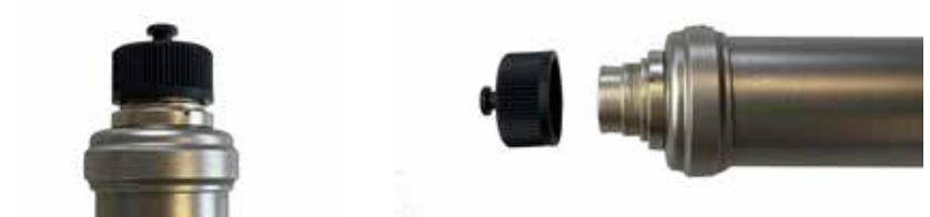
6. Zum Verbinden des Austausch-Handgerätes mit der Anschlussleitung darauf achten, dass sich der Verpolungsschutz des Steckers (Handgerät) direkt gegenüber vom Verpolungsschutz der Buchse (Anschlussleitung) befindet. Anschließend den Steckverbinder der Anschlussleitung auf den Handgerätesteckverbinder aufsetzen und bis zum spürbaren Anschlag (ca. 3 mm) vorsichtig und gerade einstecken.
